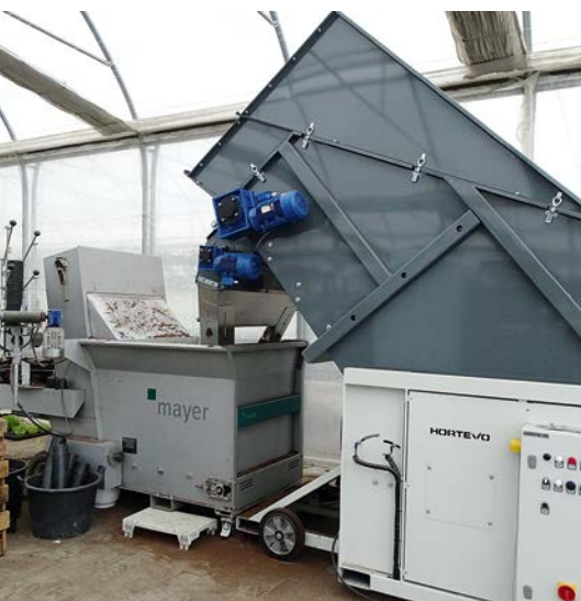
Fot. 13. Rozdrabniacz Hortevo do podłoża torfowego, współpracujący z doniczkarką Mayer TM 1610
